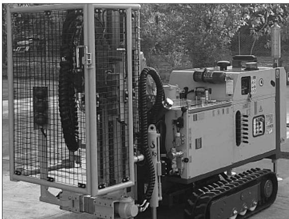
Fig. 4: Perforazioni con mast in verticale
