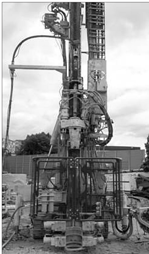
Fig. 1: Protezione dell'organo perforatore
